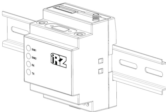
Рис. 3.1 Монтаж устройства – установка модема на DIN-рейку
