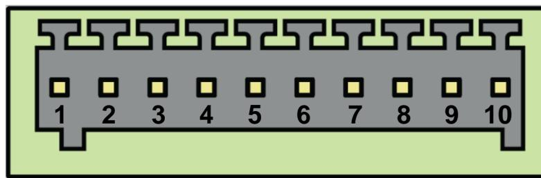
Рис. 2.8 Разрывной коннектор
